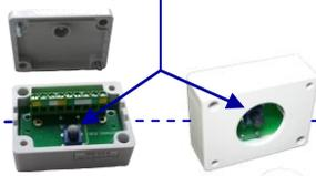
Protection mécanique du switch de détection d'arrachement.
